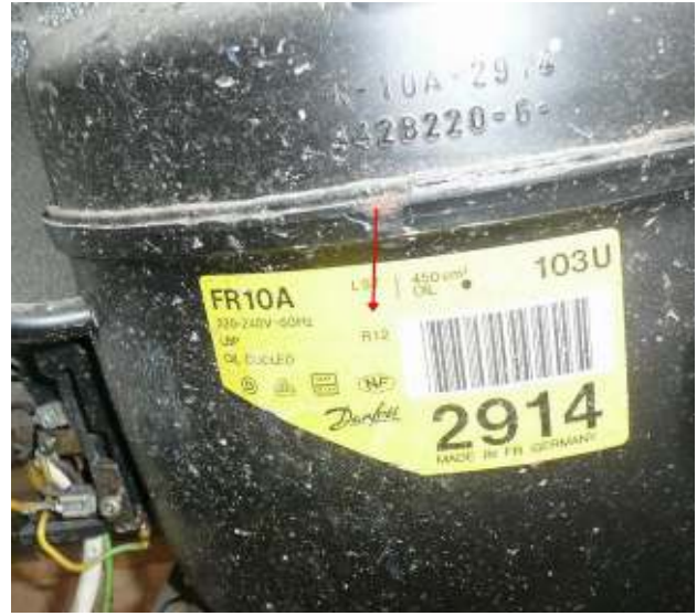
Kompressor, welcher das verbotene FCKW R12 (Dichlorodifluormethan, Freon 12) enthält - gefährlicher Abfall Compressor containing the prohibited CFC R12 (dichlorodifluoromethane, Freon 12) - hazardous waste (Photo: Hessische Abfalltransportdatenbank)
