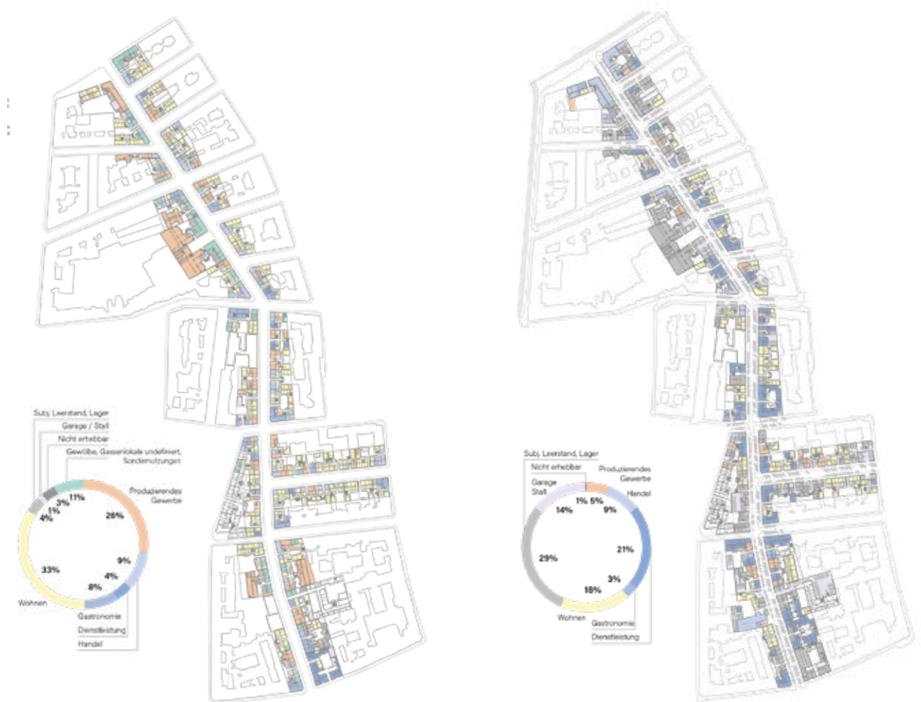
Abbildung 3: Nutzungsstrukturanalyse: Zusammenhängende Grundrissaufnahme zur Forschungsstraße A (innerhalb des Gürtels; anonymisiert), Darstellung der unterschiedlichen Nutzungen, links: um 1910, rechts: aktuell. (Psenner 2023, 118 und 119)
