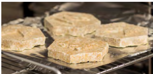
Nach dem Trocknen im Ofen hat der nachhaltige Baustoff ähnliche Dämmwerte wie Styropor; Foto: © Fraunhofer UMSICHT/Julia Kraymer
