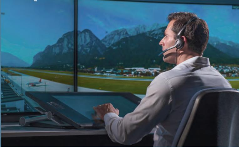
Flugsicherung von morgen: Frequentis' Remote Virtual Tower-Lösungen dienen zur Steuerung mehrerer Airports von einem Kontrollcenter aus.
