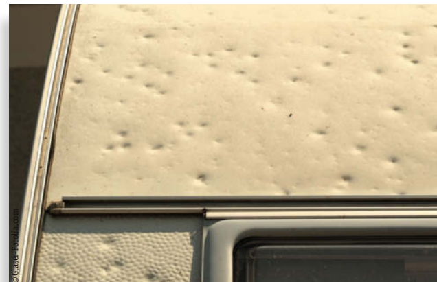
Wetterbedingte Schäden sind im Vormarsch. Gerade nach Hagelwettern.
