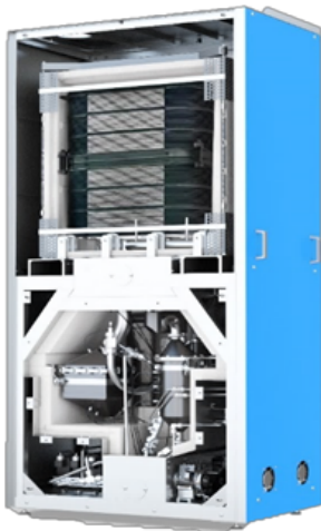
Abbildung 1: AVL SOEC Versuchsanlage im Labormaßstab
