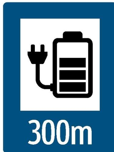
Dieses Zeichen weist auf eine E-Ladestelle hin. Im blauen Rand kann die Entfernung bis zur E-Ladestelle angegeben werden. Auf derselben Straße darf dieses Zeichen innerhalb einer Entfernung von 1000 m nur einmal in der gleichen Fahrtrichtung angegeben werden.“
