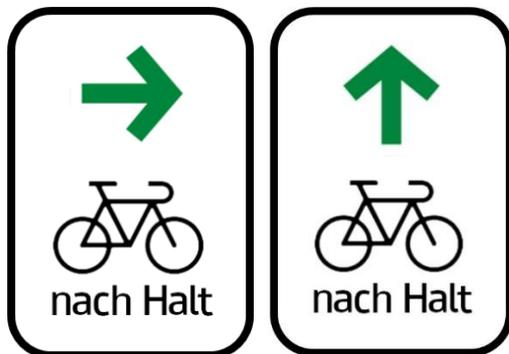
Eine solche Zusatztafel neben einem roten Lichtzeichen zeigt an, dass i. S. von § 38 Abs. 5a die Lenker von Fahrrädern trotz rotem Licht rechts abbiegen bzw. bei T-Kreuzungen geradeaus fahren dürfen.“
