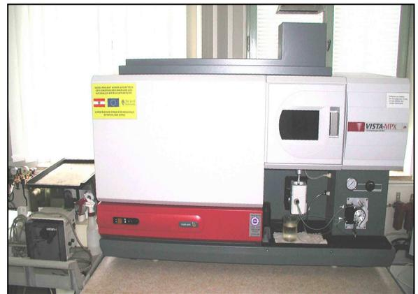
**Bild 13:** ICP-Spektrometer
