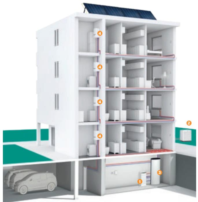
In diesem Beispiel übernimmt eine Luft/Wasser-Wärmepumpe flexoTHERM **1** mit der Außeneinheit aroCOLLECT **2** die Vorerwärmung des Heizwassers. Der zentrale Lastenausgleichsspeicher allSTOR **3** liefert das vorerwärmte Wasser an die geoTHERM 3kW Wärmepumpen **4** in die einzelnen Wohneinheiten, die die finale Wärmebereitung erledigen.
