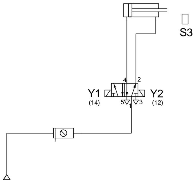
Bei der Funktionsprobe muss ein Betriebsdruck von min. 4 bar verwendet werden !
