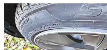
Überstehende Felge ist schnell beschädigt. Foto: schuh
