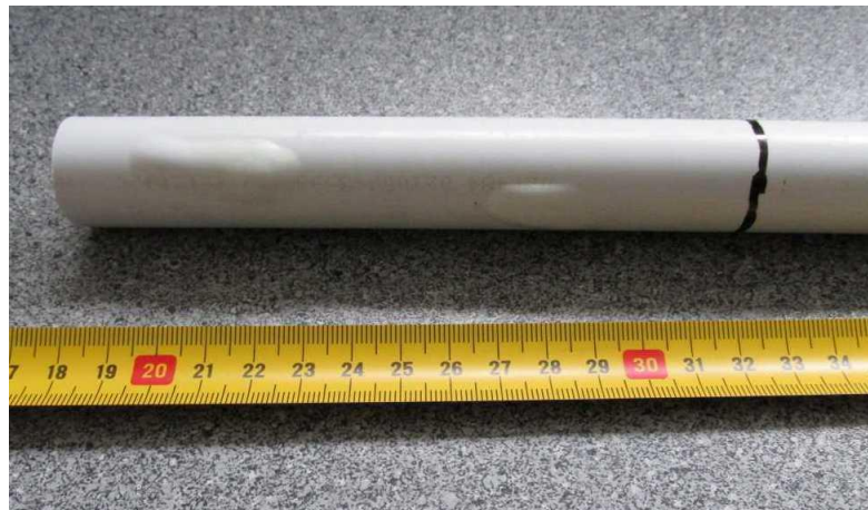
Abb.: Blasen an der Außenschutzschicht
