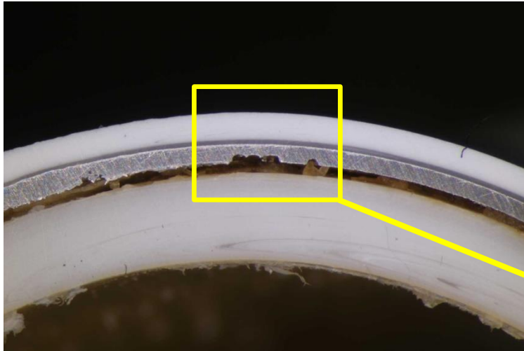
Abb.: Korrosion beginnend an der Innenoberfläche des Aluminiumrohres
