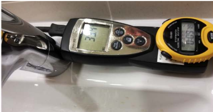
11_14_220 22.06.2018 (Früh / Vormittag) KW-Temperaturverlauf mit Zeit (am Tag davor war dort KW mit einer Temp. von ca. 16°C => Erwärmung über Nacht).
