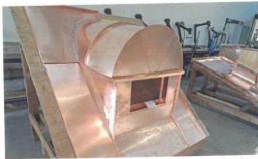
Die praktischen Arbeiten der Meisterprüfung bestehen aus komplexen Aufgaben. Hier eines der Meisterstücke der Spenglerprüfung. Foto: Franz Geretschläger
