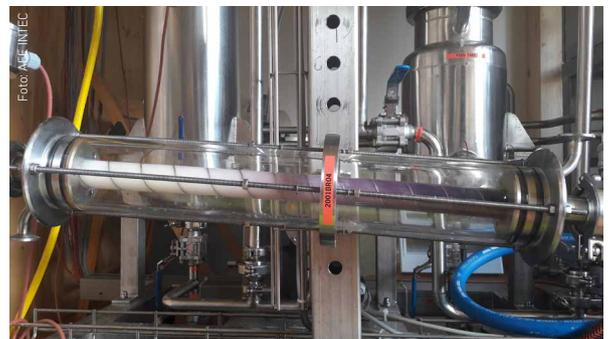
Der oszillierende Reaktor: Durch die Einfärbung ist die überlagernde Pfropfenströmung gut zu erkennen.
