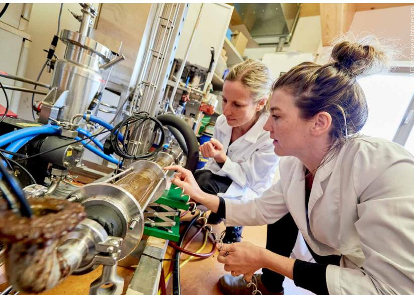
Der von AEE INTEC entwickelte oszillierende Reaktor könnte diese Lücke schließen. Das hat das Projekt HIPSTERS gezeigt, in dem Forschende von AEE INTEC und der TU Graz den Einsatz des oszillierenden Reaktors für die Extraktion von Proteinen aus Biotreber testeten. Auftraggeber des Projekts war der Zukunftsfonds Steiermark im Förderverbund des Land Steiermark und der Stadt Graz. In den Versuchen mit Suspensionen aus Biotreber lieferte das Verfahren vielversprechende Ergebnisse.
