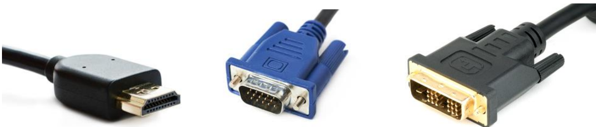
(von links): Ein HDMI-Kabel zur Datenübertragung, ein VGA- und ein DVI Kabel zur Bildübertragung
