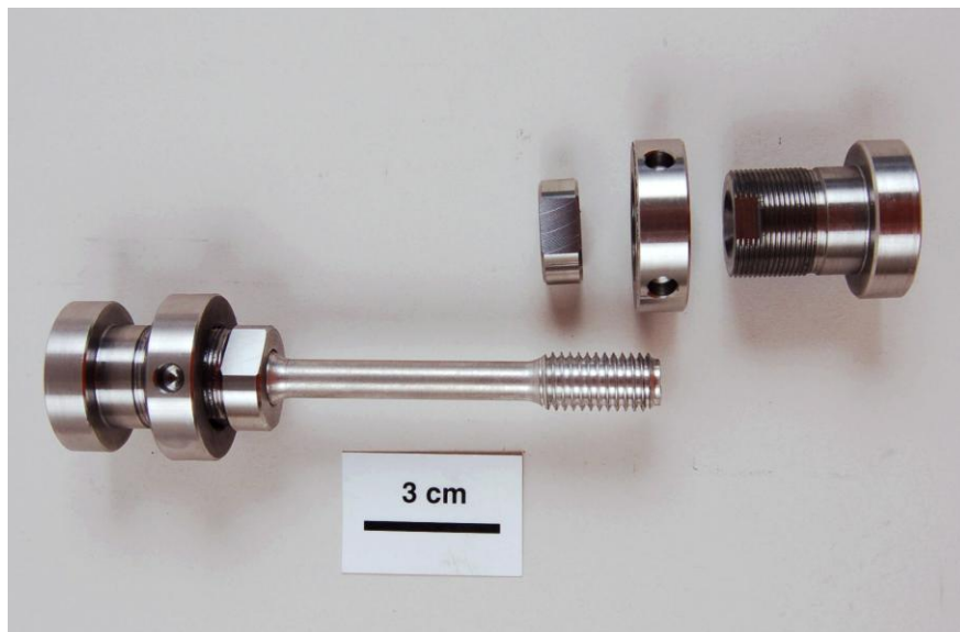
Bild 8: Optimierter Adapter für Kleinproben-Prüfung aus Titan (mit Kontermutter)
