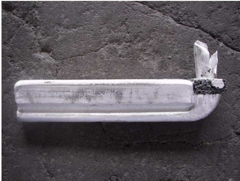
Bild 7: Diez-Stab-Probe, Abguss mit Filter
