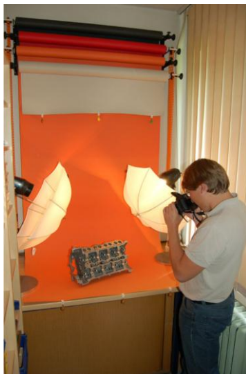
Bild 12: Fotostudio zur visuellen Inspektion von Gussteilen
