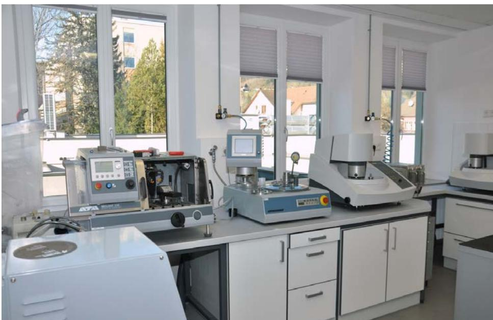
**Bild:** Präzisionssägen und Poliermaschinen im Nassbereich der Metallographie.
