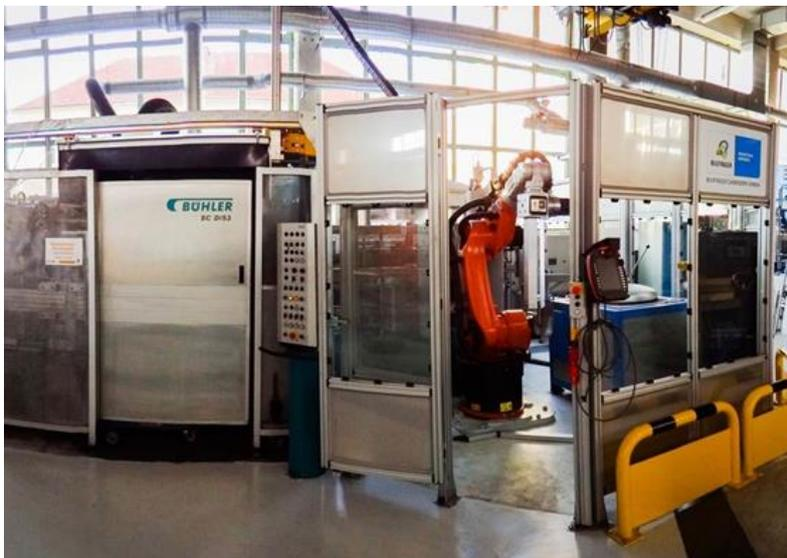
**Bild 13:** Vollautomatisierte DG-Zelle
