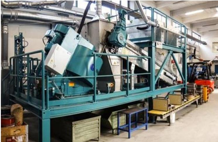
**Bild 11:** Eirich-Mischer mit Absaugung
