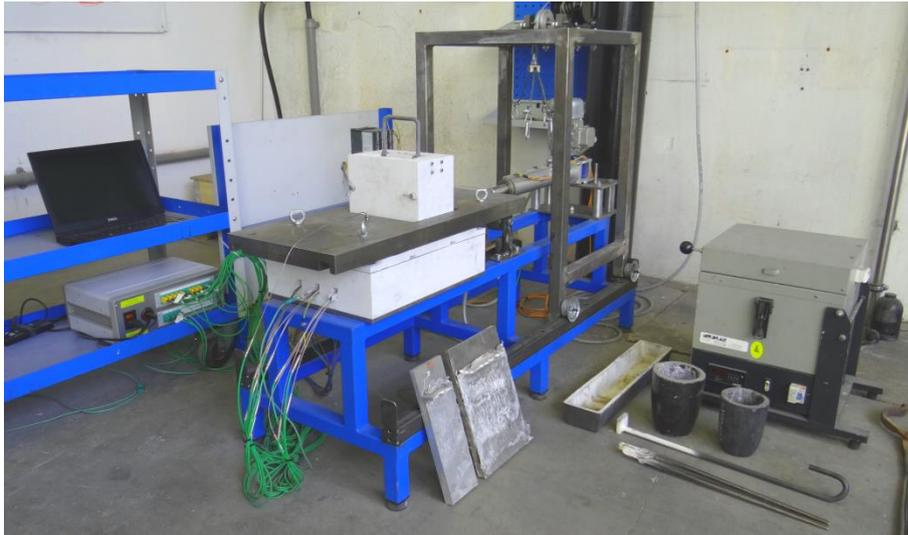
**Bild 3:** Kleinanlage zur Durchführung von Verbundgussversuchen
