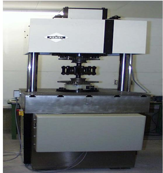
**Bild 11:** Resonanzfrequenzprüfmaschine
