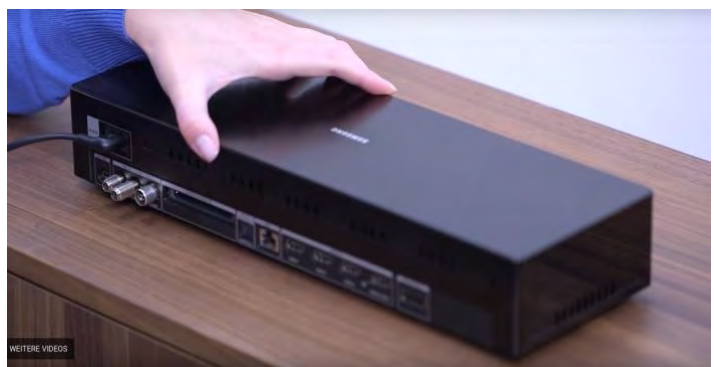
Die One Connect Box übernimmt die Verkabelung für das TV-Gerät, das mit nur einem Kabelanschluss auskommt.
