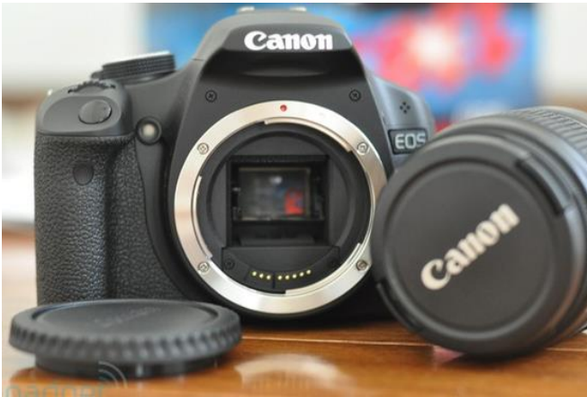
Das Gehäuse einer Spiegelreflexkamera mit abgenommenem Objektiv. Deutlich erkennt man den Spiegel, der das Bild auf den Sensor, auch Bildwandler genannt (rechts) umleitet. (Fotos: Canon, Nikon)
