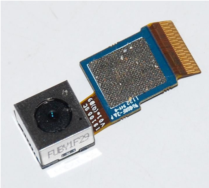
Smartphone-Kamera. Nur 8x8 mm „klein“. (Foto: Mehnert)
