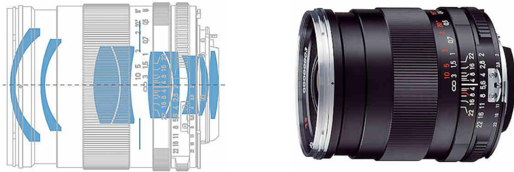
Die Grafik zeigt den Aufbau eines Spezial-Objektives (rechts) von Carl Zeiss mit zahlreichen Linsen, die je nach Stellung zu einander ein Objekt näher erscheinen lassen oder weiter entfernt. (Fotos: Carl Zeiss)
