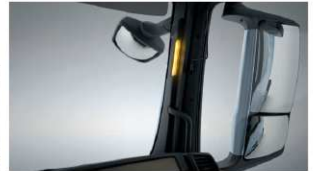
Anzeige einer drohenden Kollision Alle drei Warnleuchten des LED-Bands leuchten.
