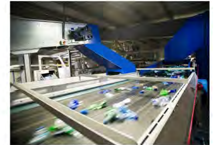
Die PET to PET-Sortiermaschine Bild: © Andi Bruckner / PET to PET
