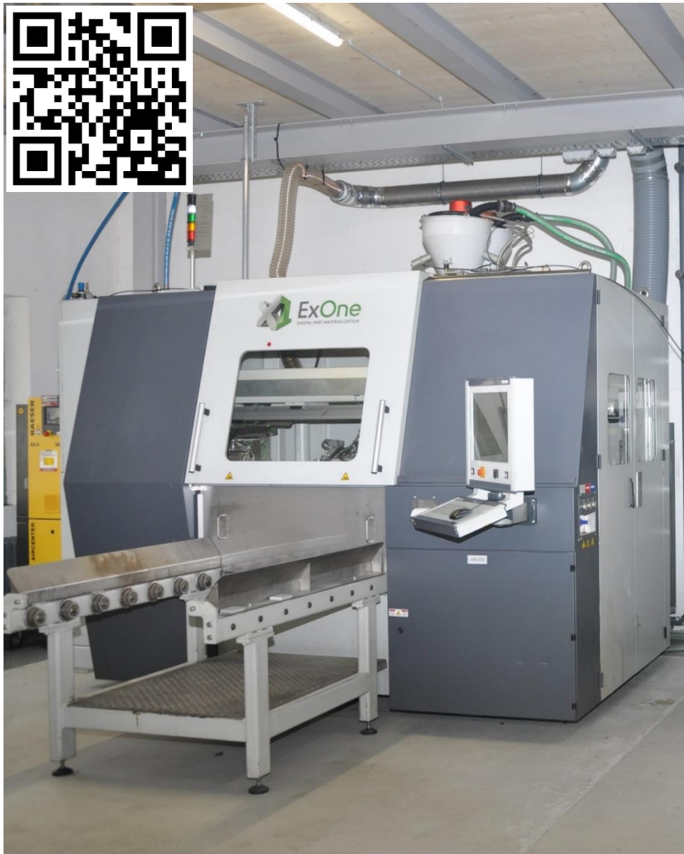
Bild 5: Neuer 3D-Sanddrucker S-Print (ExOne) am ÖGI; der QR-Code führt zu einem Beispielvideo zum 3D-Sanddruck am ÖGI.
